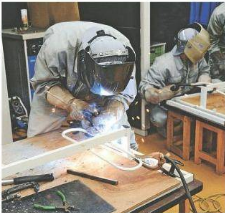
生徒が溶接に取り組み、テーブルの補修作業のため
