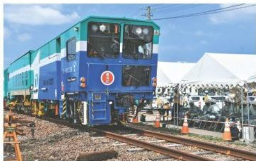
線路のゆがみを修正する車両「マルチプル・タイタンバー」
